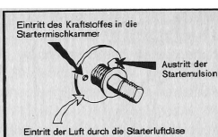
Bild 53: einfacher Starter- drehschieber
