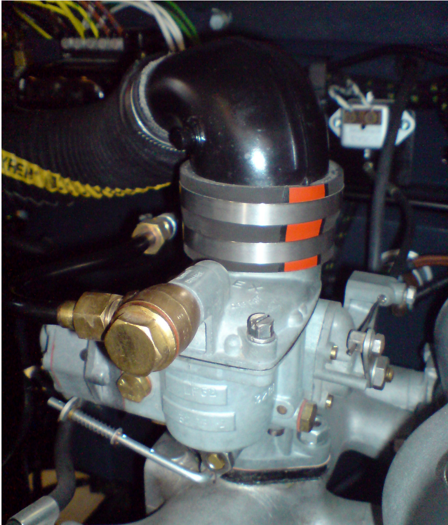
Solex 32 PBI-2 nach der Revision, eingebaut im 107“
